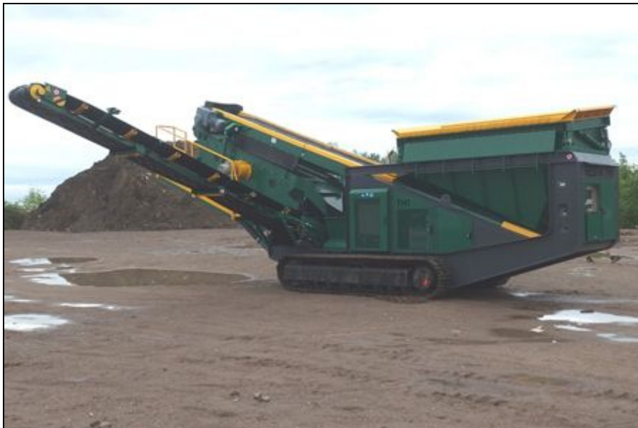
Obr. 5. Příklad použité recyklační linky: Jednotka Resta TH1 (zdroj: www.resta.cz )
